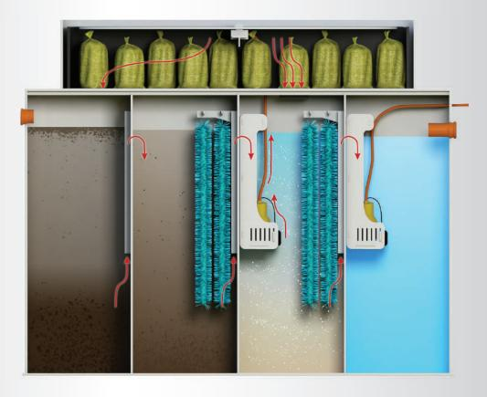
Сточные воды из жилого дома по канализационным трубам самотеком поступают в приёмную камеру  $N^2$ 1, где основная часть взвешенных веществ оседает на дно камеры и таким образом задерживается, а незначительная поднимается на поверхность сточных вод.
